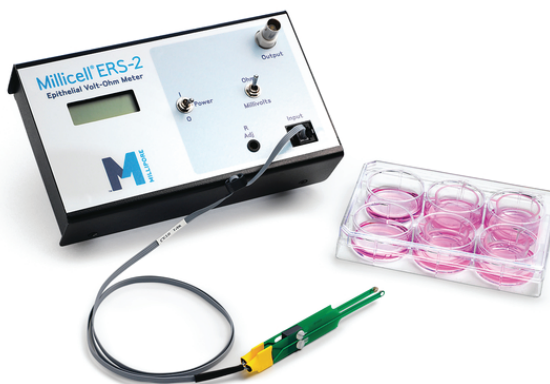
Figura 29. Representación de la medida de la resistencia eléctrica transepitelial (TEER).
