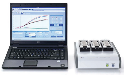
Figura 26. Equipo xCELLigence RTCA DP para determinar proliferación, migración e invasión celular.
